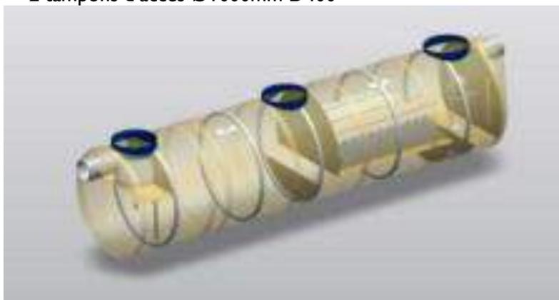
Le séparateur hydrocarbure de dimensions Ø2150mm L=8000mm sera posée à une profondeur de 3,50m (fond de châssis) soit un terrassement à 4,00m (fond de lestage). Le niveau de la mer (à vérifier) étant à + 0,14m NGF et le fond de terrassement à -2,10m NGF, la cuve sera en grand partie immergée soit 2,25m sous le niveau de l'eau
